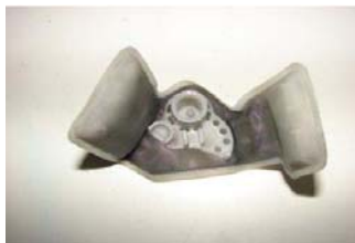
Figura 9: Filtro interno da eletrobomba que continha combustível adulterado.
